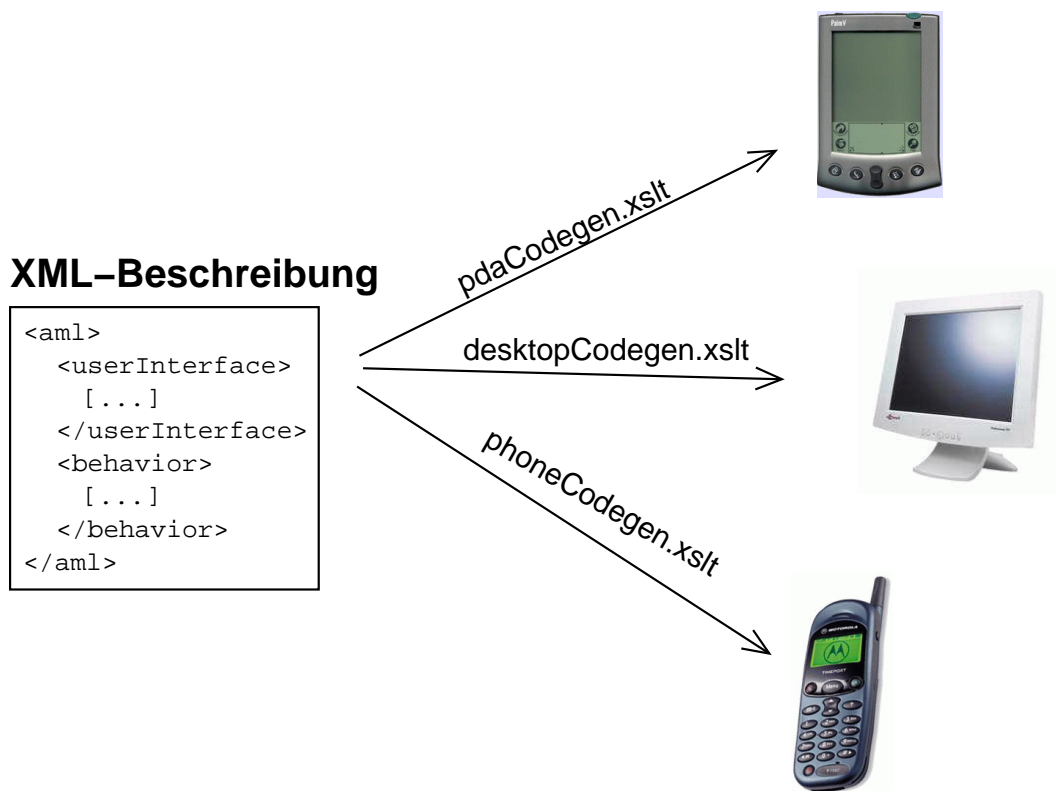
Abbildung 3.4: Plattformunabhängigkeit der XML-Beschreibung
